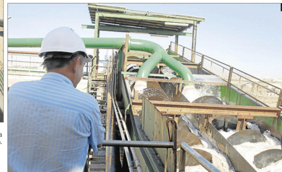
LA EXTRACCIÓN DE LA SAL REQUIERE de una maquinaria muy pesada, tanto estática como móvil. 1. Imagen del último paso, cuando la sal llega limpia y se acumula ya preparada para tratarla en la fábrica de la sal. 2. Cinta transportadora que lleva la sal hasta el lavadero. Esta cinta sale de la máquina que recoge la sal traída por las barcas. 3. Un momento de la llegada de las barcas. Entran por un canal y el volquete gira 90 grados para que caiga. La máquina la recoge y la traslada a la cinta. 4. La máquina lavadora. Aquí se utiliza la propia agua de las salinas para evitar la disolución. © TPDS
