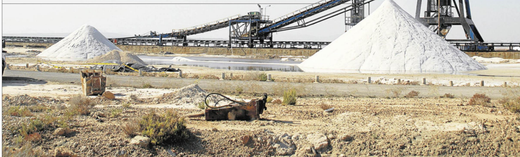
LA EXTRACCIÓN DE LA SAL REQUIERE de una maquinaria muy pesada, tanto estática como móvil. 1. Imagen del último paso, cuando la sal llega limpia y se acumula ya preparada para tratarla en la fábrica de la sal. 2. Cinta transportadora que lleva la sal hasta el lavadero. Esta cinta sale de la máquina que recoge la sal traída por las barcas. 3. Un momento de la llegada de las barcas. Entran por un canal y el volquete gira 90 grados para que caiga. La máquina la recoge y la traslada a la cinta. 4. La máquina lavadora. Aquí se utiliza la propia agua de las salinas para evitar la disolución. © TPDS
