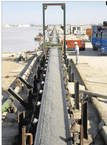
LA EXTRACCIÓN DE LA SAL REQUIERE de una maquinaria muy pesada, tanto estática como móvil. 1. Imagen del último paso, cuando la sal llega limpia y se acumula ya preparada para tratarla en la fábrica de la sal. 2. Cinta transportadora que lleva la sal hasta el lavadero. Esta cinta sale de la máquina que recoge la sal traída por las barcas. 3. Un momento de la llegada de las barcas. Entran por un canal y el volquete gira 90 grados para que caiga. La máquina la recoge y la traslada a la cinta. 4. La máquina lavadora. Aquí se utiliza la propia agua de las salinas para evitar la disolución. © TPDS
